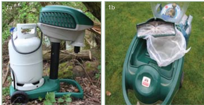
Figuur 1a en 1b: De val (1a: zij aanzicht) die gebruikt wordt om de verspreiding van muggen in België te onderzoeken. De val gebruikt propaan dat wordt omgezet in CO 2 , H 2 O en warmte. De muggen worden opgezogen in een netje boven in de val (1b). (foto's ITG)
