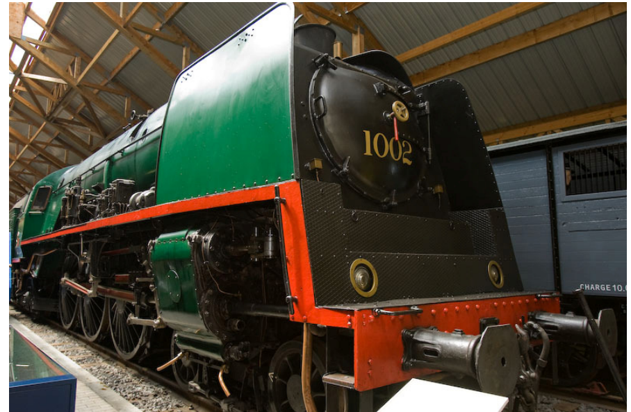
Stoomlocomotief 1002 (126 ton, 2545 pk), in 1935 gebouwd door het Consortium Belge de Constructeurs de Locomotives die al enkele jaren overgebracht werd van de Museumbewaarpplaats in Leuven naar Treignes. Foto picasaweb.google.com
