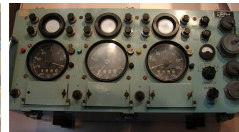
Serrel BPC3 nr.37 Plaatsbepaling met drie radiosignalen
