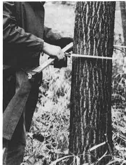
Automatische meetklem waarbij diametermetingen rechtstreeks in de computer opgeslagen worden.
