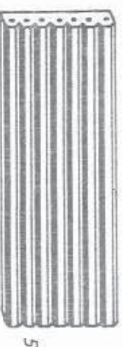
De ruwe potloden worden uit de plankjes gefreesd
