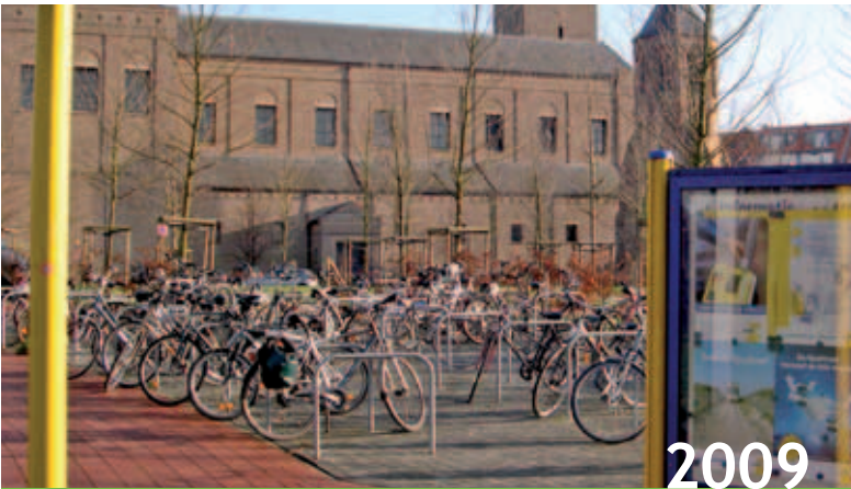
Halte De Lijn Knokke Stabiele fietsbeugels met voldoende ruimte tussen zijn de basis voor een comfortabele fietsenstalling. De fiets kan met het kader en de onderdelen vastgemaakt worden aan de stalling, wat het een stuk moeilijker maakt voor fietsendieven.
