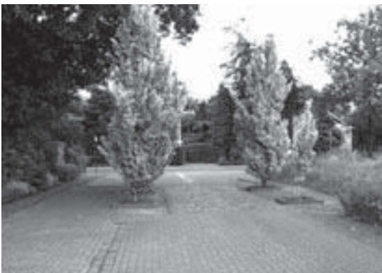
En er kan een rammelstrook in kasseitjes worden aangelegd, maar dan - anders dan hier in de Kallohoekstraat te Sint-Niklaas - boven op een verkeersplateau.
