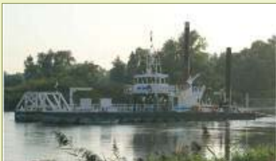
Het baggerschip 'Ouisseham' van Ghent Dredging is uitgerust met een reusachtige draaiende snijkop en heeft sinds juni 2012 al tweehonderd duizend kubieke meter zand uit de Durme gehaald.
