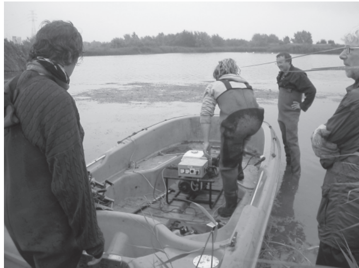
Op de boot bevindt zich een generator om het elektrisch vissen mogelijk te maken. Foto: Koen Vanagtmael.
