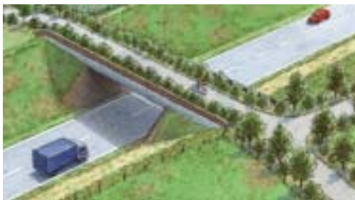
Figuur 4 Geleidingselementen naar en over viaduct.
