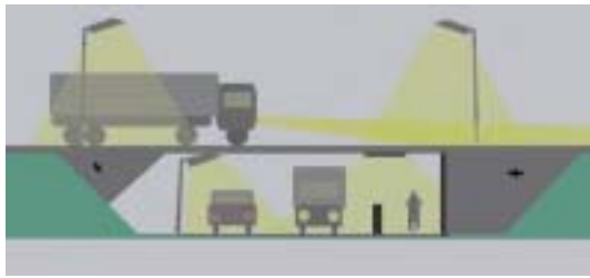
Figuur 8 Naar het wegdek gerichte, van boven afgeschermd, vleermuisvriendelijke verlichting bij viaduct. Tekening Herman Limpens.
