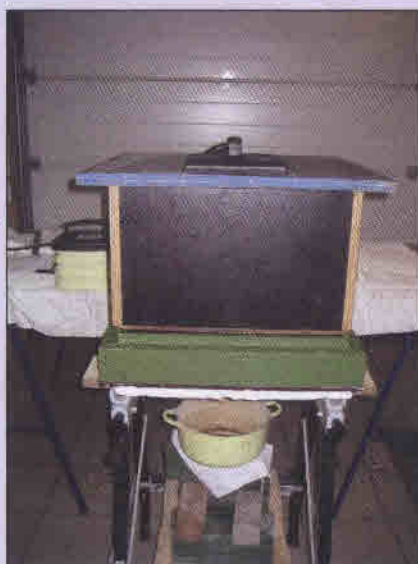
Foto 2 De wassmelter (WS) geplaatst op een 'Work-Mate'. Onder de WS bevindt zich een recipiënt om de was in op te vangen
