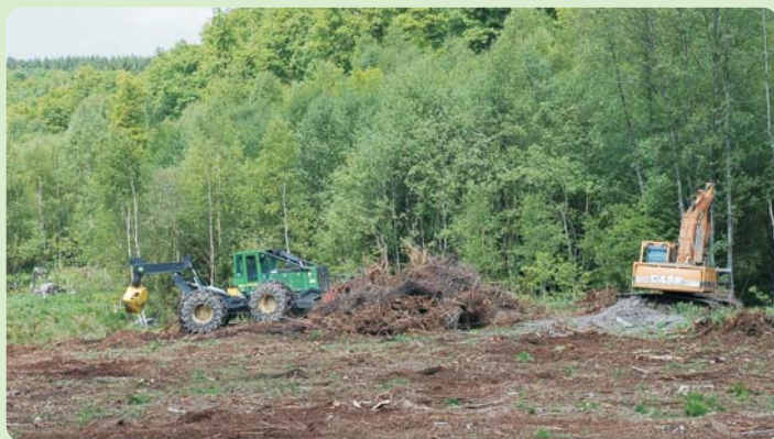
Utilisation conjointe du tracteur et de la grue lors de l'andainage. Cliché Ch. Xhardez
