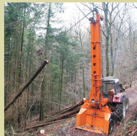
Le câblage des arbres entiers est une technique utilisée dans les fortes pentes ou dans les milieux très humides. Cliché D. Doucet
