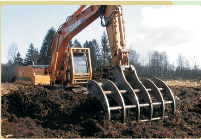
Râteau andaineur monté sur un bras hydraulique. Cliché Fr. Degrave
