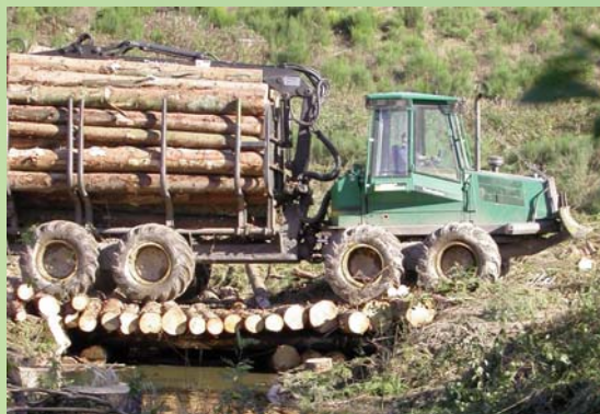
Le passage des bois sur une passerelle temporaire en billons permet d'éviter l'altération des berges et le rejet de sédiments fins dans les cours d'eau.
